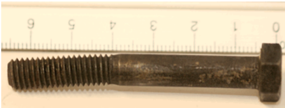
Figura 6. Tornillo trasero del lado izquierdo del tren principal
