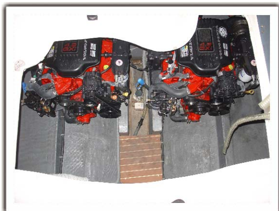
Figura 6. Vista del compartimento de motores de una embarcación modelo LEMA DUNA 290 (motores de gasolina) desde la abertura de acceso en cubierta
