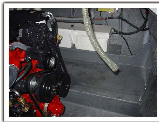
Figura 7. Baterías en el costado de babor-proa del compartimento de motores de una embarcación modelo LEMA DUNA 290
