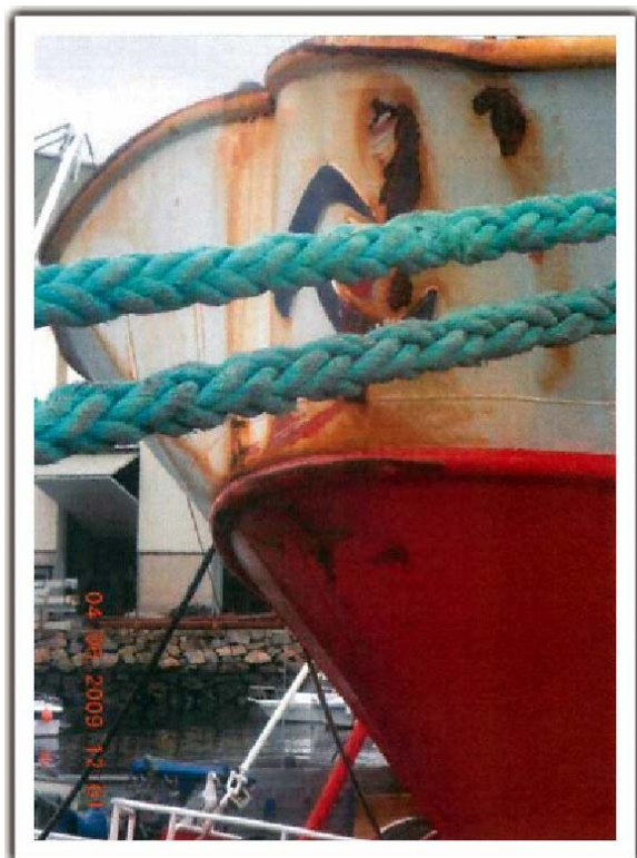
Figura 5. Daños en la amurada del B/P ANCHOUSA
