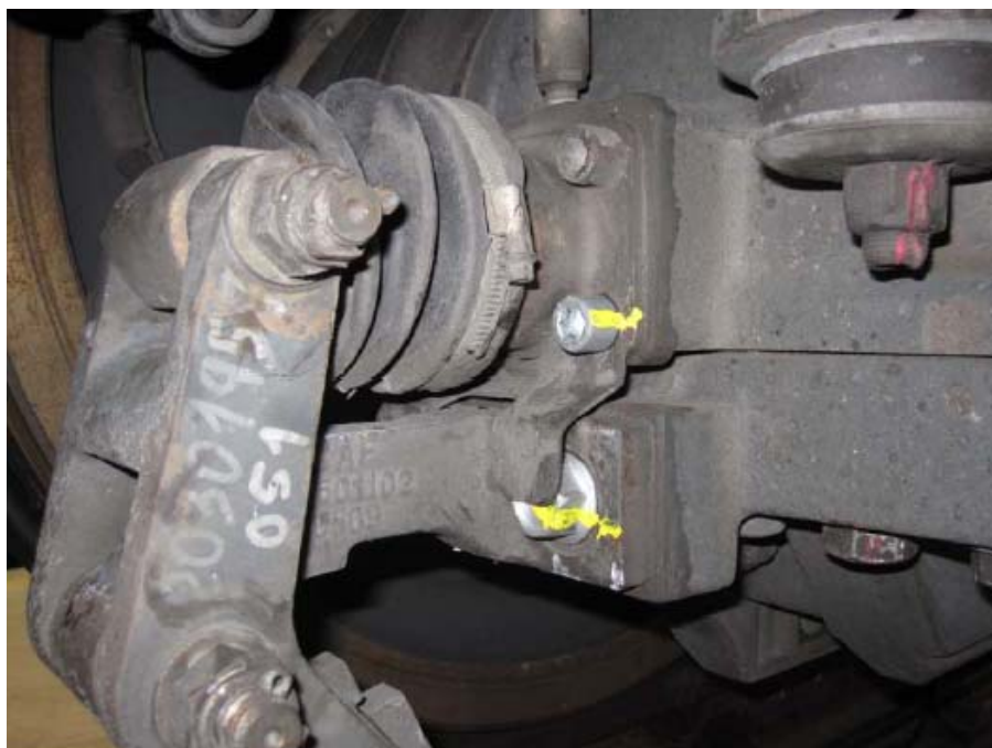
Vista de un mecanismo de bloqueo de ancho de rueda en buen estado: los tornillos de sujeción bien dispuesto, chapa tope de seguridad sin deformar y señal de comprobación del apriete correcto. (Fuente: Renfe Operadora)
