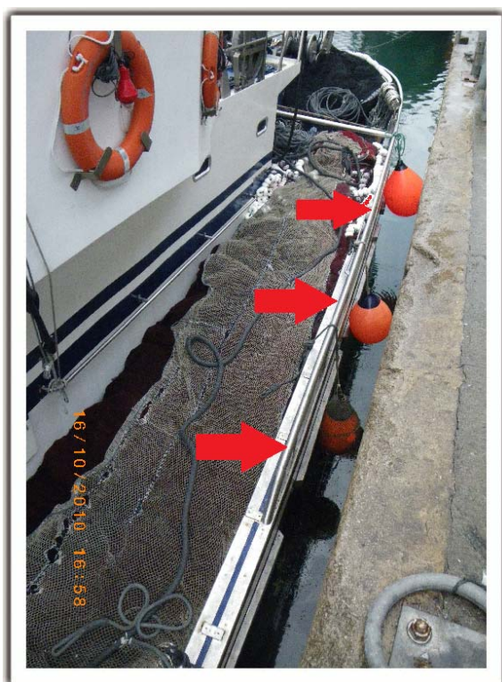
Figura 4. Banda de babor del buque, con las redes estibadas. Las flechas señalan el tubo de acero sobre la regala para aumentar su altura
