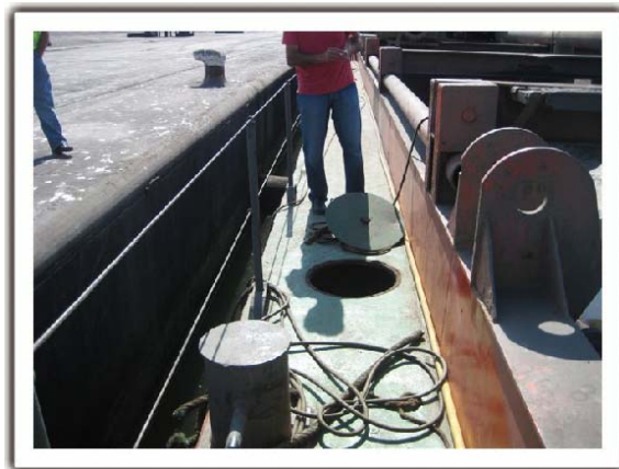
Figura 2. Abertura del compartimento lateral estanco 3-Br
