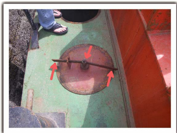
Figura 3. Vista de la parte inferior de una tapa y su travesaño (indicado por flechas rojas)
