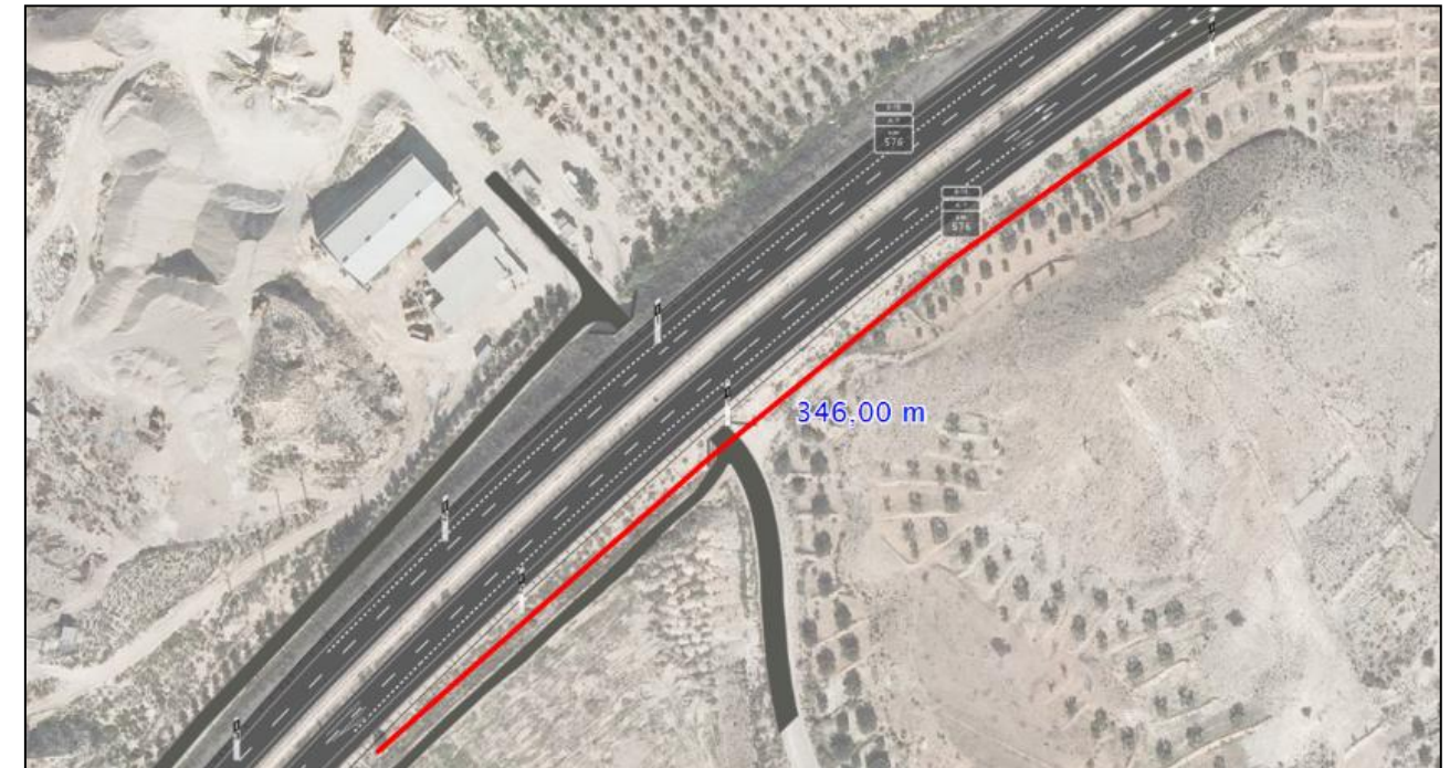
Estado actual ramal de salida A-7, Carril tipo Paralelo de 346 m
