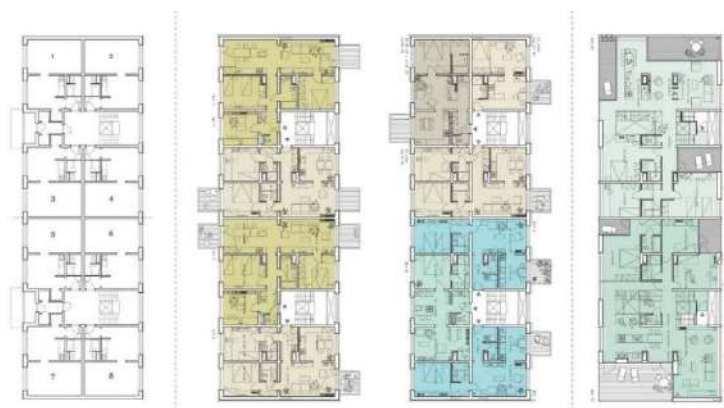
Figura 5.57. Edificio Prefabricado en Rimavská Sobota (Eslovaquia) con transformación completa de la distribución en planta/ GutGut arquitectos.
