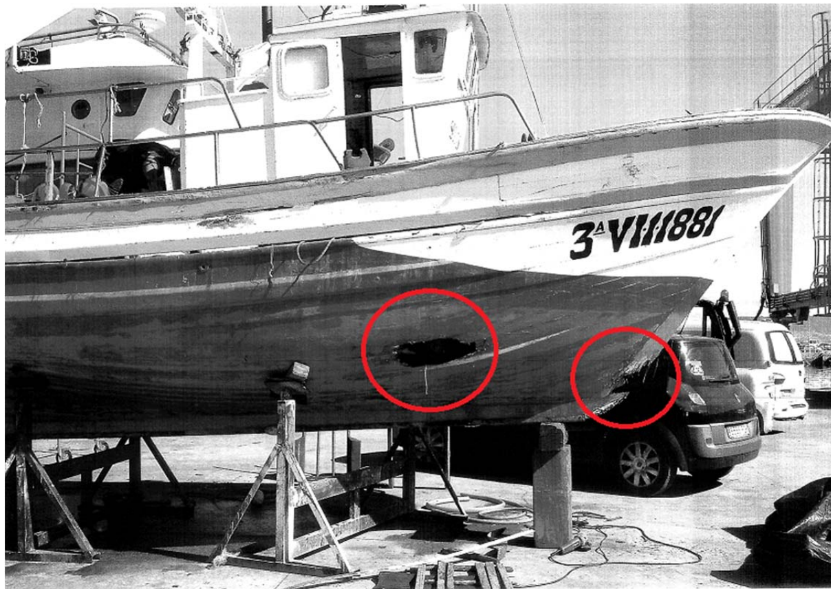
Figura 3. Pesquero SOY DEL MAR en el varadero tras su reflotamiento. Los círculos rojos señalan los daños estructurales más importantes
