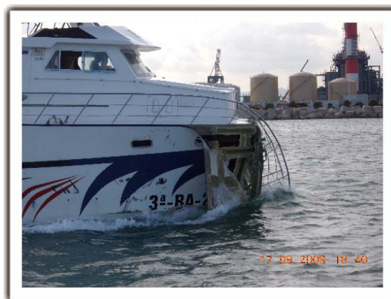
Figura 2. Daños en la proa del pesquero
