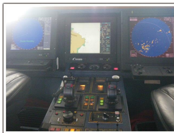
Figura 5. Panel central de mandos del ALGECIRAS JET con los asientos del capitán y el primer oficial, pantallas de radar de babor y estribor y consola ECDIS.
