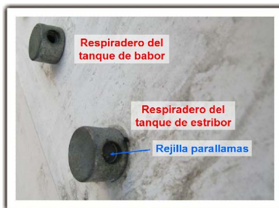
Figura 8. Vista de los respiraderos por la parte exterior del casco
