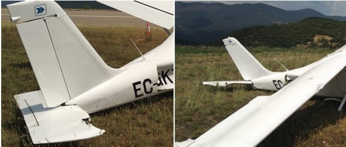
Figura 5. Daños en fuselaje y estabilizador
