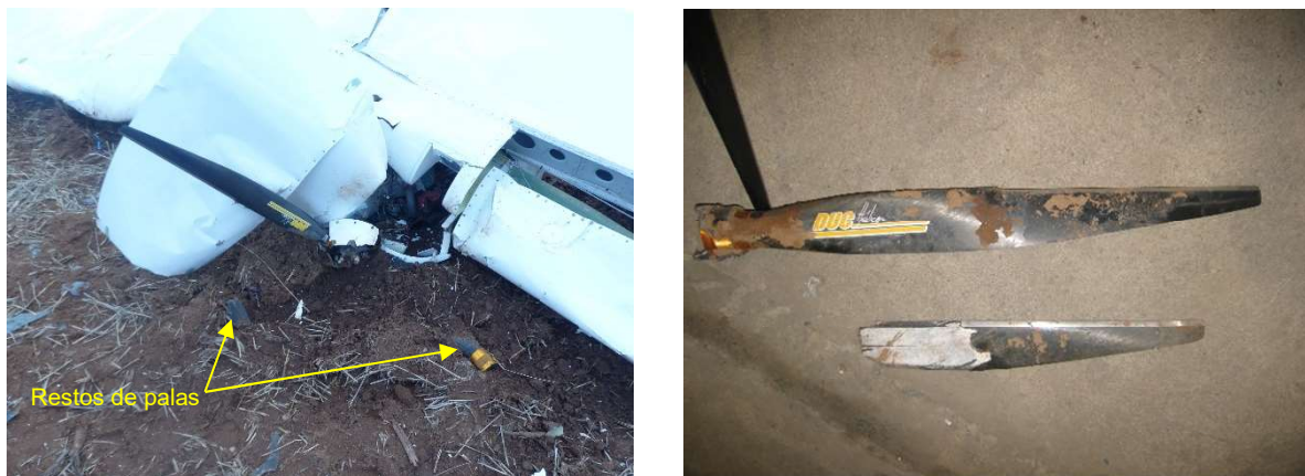
Figura 4. Fotografía de la hélice y palas desprendidas en el lugar del accidente (izquierda) y de las palas desprendidas tras su traslado a la nave (derecha)
