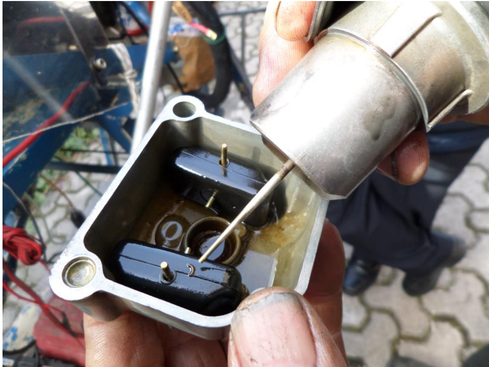
Fig. 6: Impurezas metálicas en cubeta del carburador de los cilindros 2 y 4
