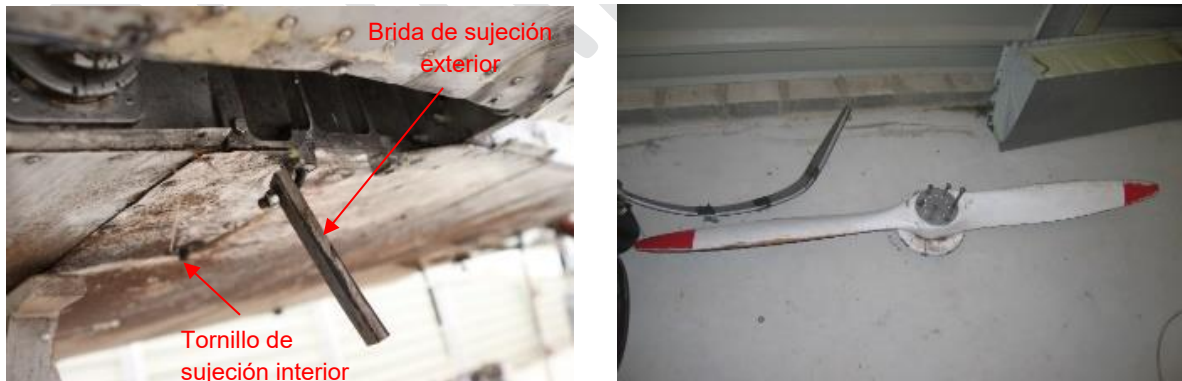
Figura 5. Fotografías de la sujeción tren principal derecho (izquierda) y de la hélice (derecha)
