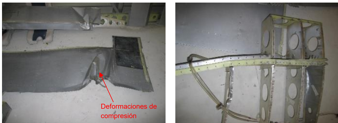
Figura 6. Fotografías del revestimiento del extradós (izquierda) y larguero principal (derecha) del semiplano izquierdo
