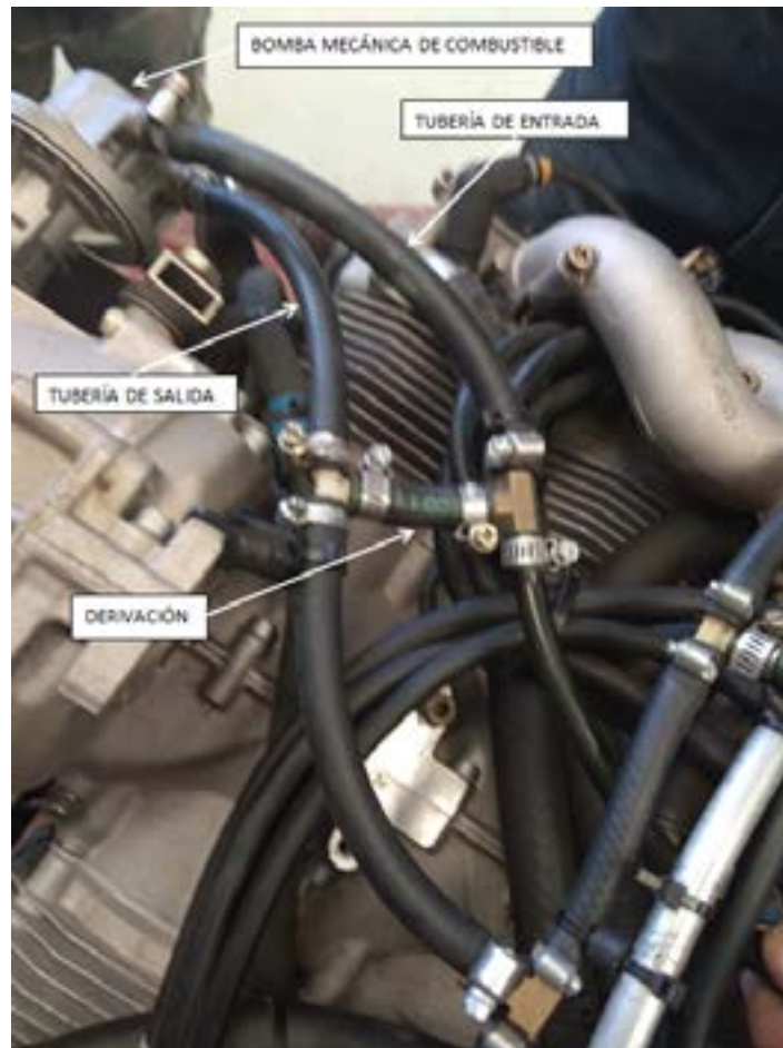
Figura 5. Instalación de tuberías de combustible
