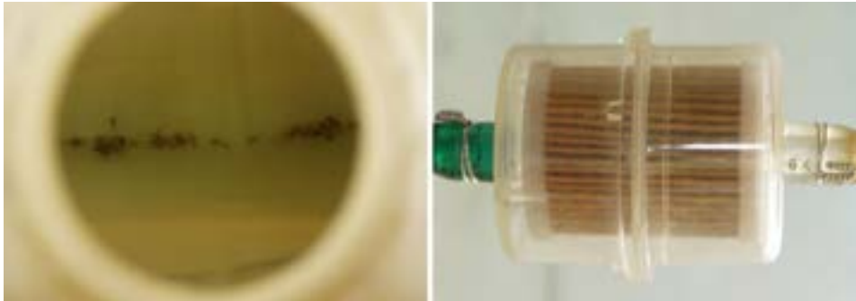
Figura 4. Residuos en depósito y filtro de gasolina
