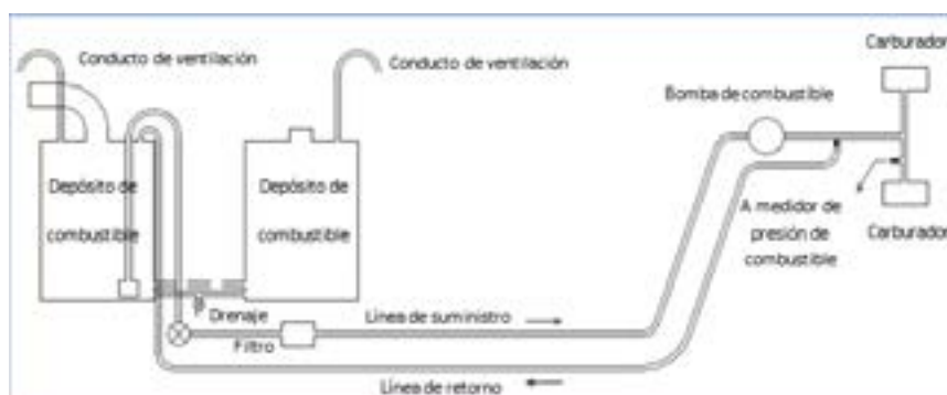
Figura 7. Esquema del sistema combustible
