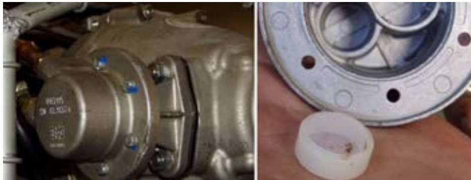
Figura 6. Bomba mecánica de combustible y filtro interno
