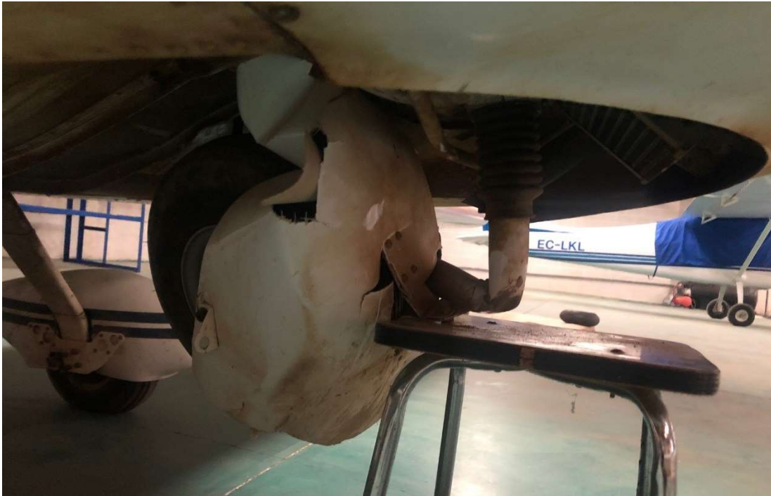
Figura 4 – Daños en pata de tren de morro.
