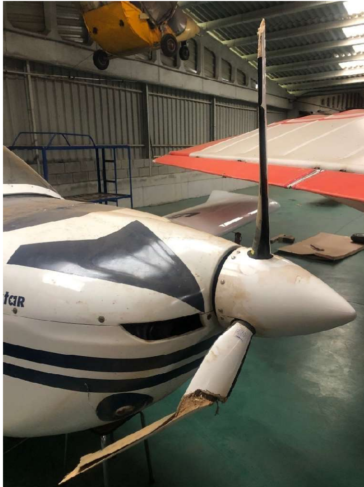
Figura 6 – Daños en las palas de la hélice.
