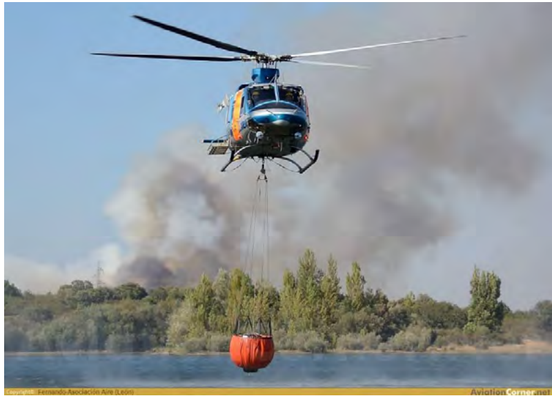
Figura nº 1.- Helicóptero Bell 412 cargando agua en labores de lucha contra incendios
