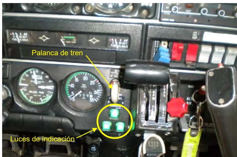
Figura 3. Fotografía del área del panel de la aeronave en la que se encuentran la palanca de tren y las luces de indicación
