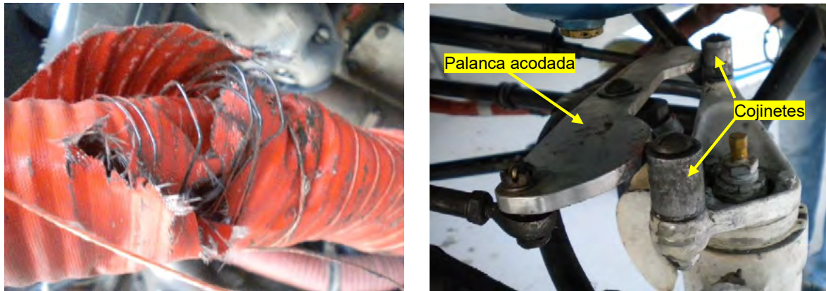
Figura 5. Detalle de la zona rota de la tubería (izquierda) y de la palanca acodada y los cojinetes del sistema de control de dirección entre los que quedó atrapada.
