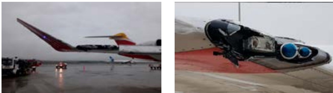
Ilustración 1: Detalle de los daños a la aeronave
