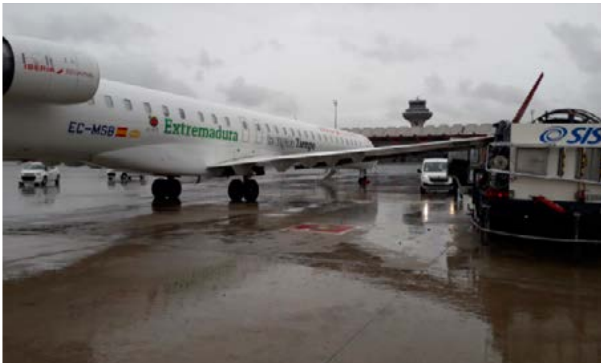
Ilustración 7: Detalle de cómo quedó la aeronave tras impactar con el camión de repostaje de combustible
