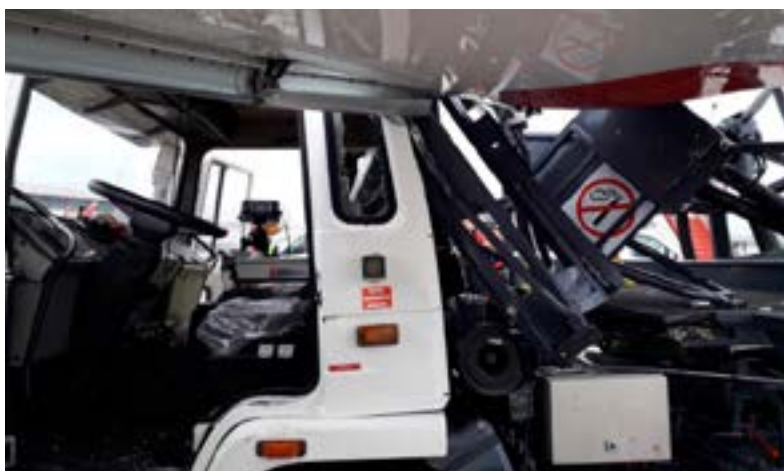
Ilustración 2: Detalle de los daños en el camión de repostaje de combustible
