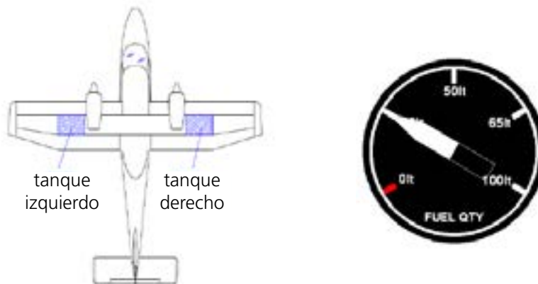
Figura 2. Tanques de combustible e indicación en cabina
