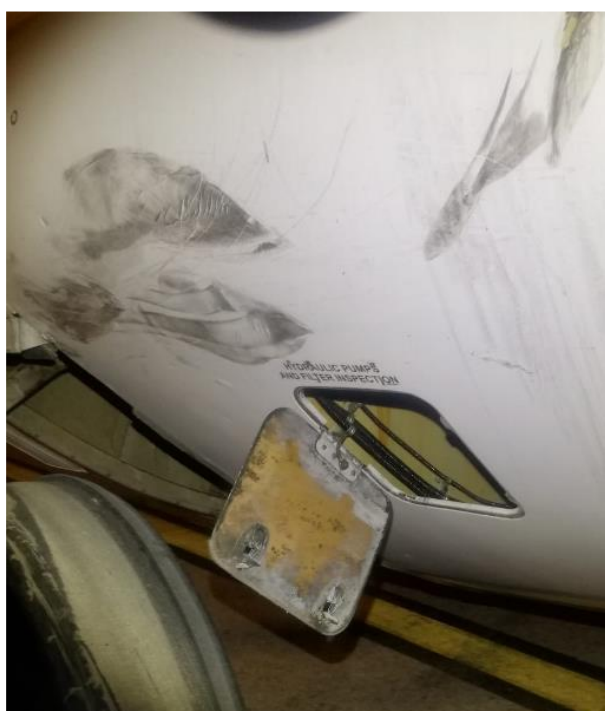
Fig.4.- Inspection panel y rubber marks
