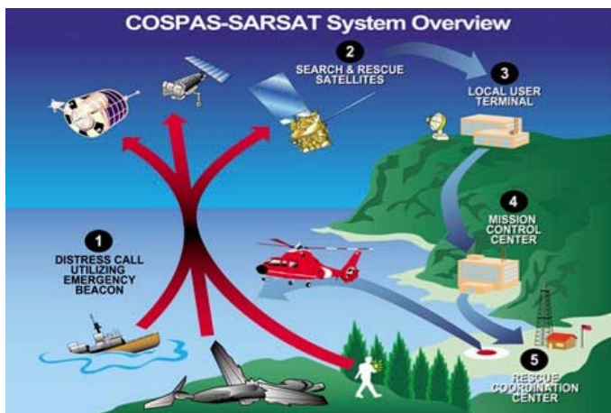
Figura 4. Esquema del sistema COSPAR-SARSAT
