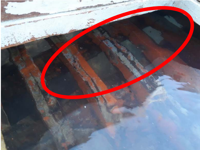
Figura 5. E/P MARINA brecha en el casco tras encallar.
