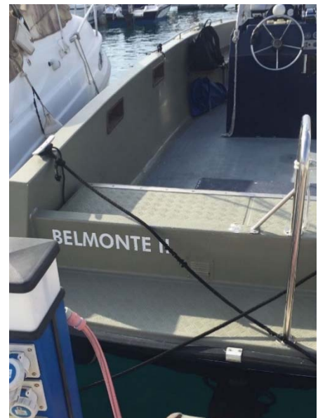
Figura 9. Detalle del asiento de popa y del cerramiento de la bañera de la BELMONTE SEGUNDO
