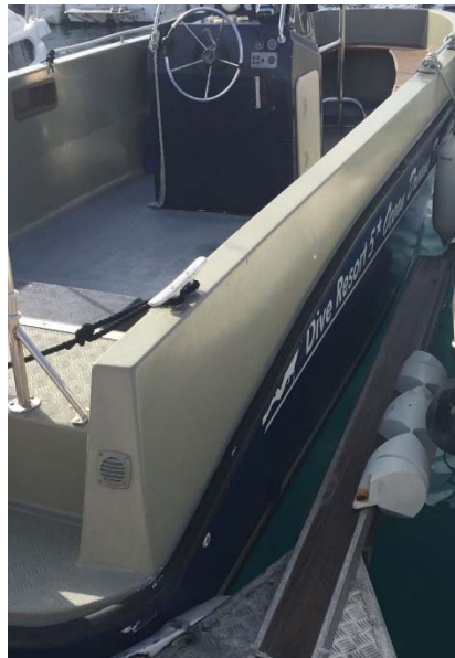
Figura 8. Costado de estribor de la BELMONTE SEGUNDO desde popa. No se aprecian más aberturas que una de pequeñas dimensiones a popa, probablemente de ventilación del espacio de máquinas
