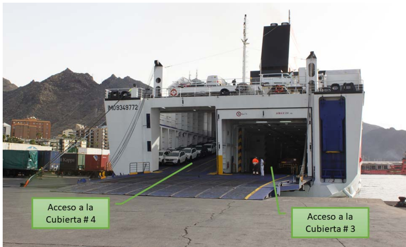
Figura 4. El CIUDAD DE PALMA atracado, popa al tacón de embarque de carga rodada, con la rampa abajo, en el puerto de Santa Cruz de Tenerife.
