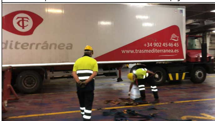
7. Plataforma en posición. El conductor frena la cabeza tractora. Los tripulantes cogen material de trincaje
