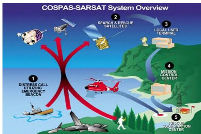
Figura 5. Esquema del sistema COSPAS-SARSAT
