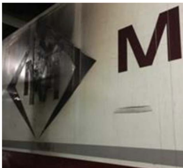
Figura 6. Remolque de camión afectado por las llamas en un lateral
