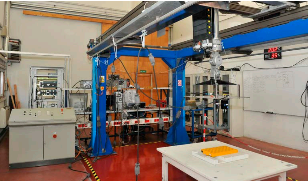
Ensayo de certificación de una eurobaliza en el LIF
