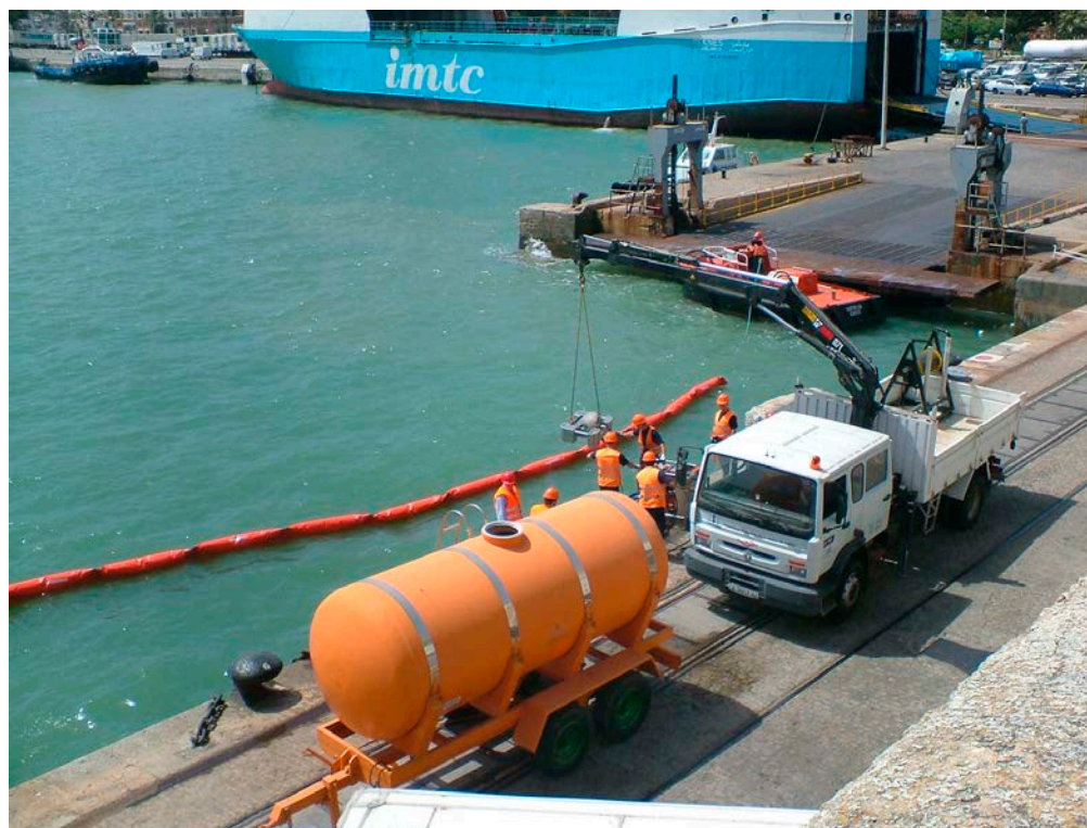
Ejercicios simulacro de vertido de líquidos contaminantes en aguas portuarias: extensión de barreras anticontaminación desde el muelle
