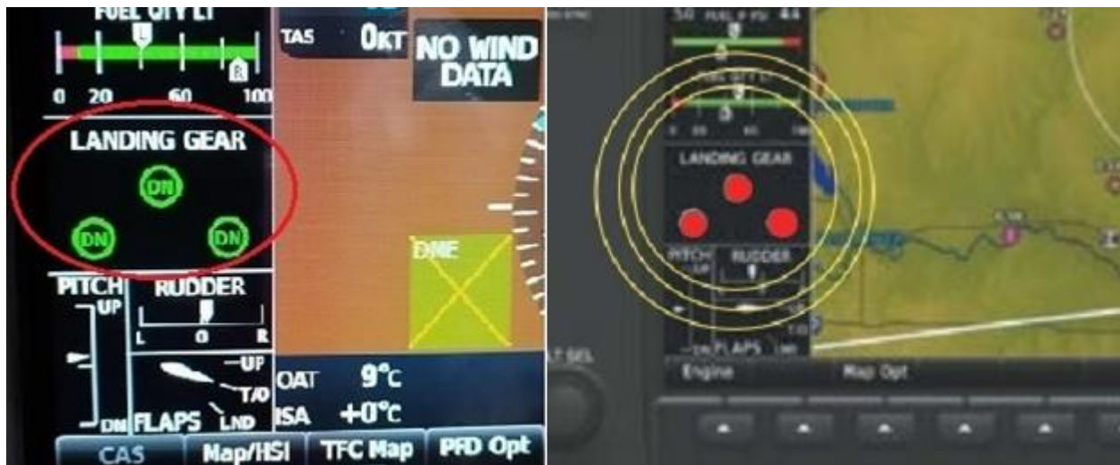
Figura 11. Luces indicadoras del tren en cabina
