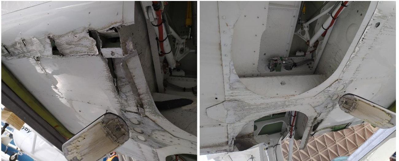
Figura 5. Daños en parte inferior del fuselaje
