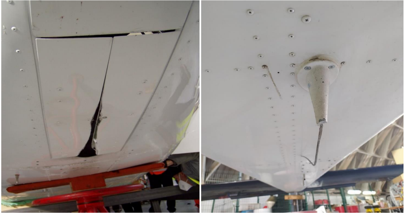
Figura 6. Daños en compuerta de pata de morro y antena
