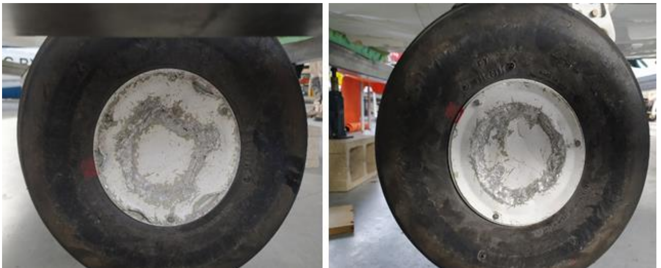
Figura 7. Daños en llantas de las ruedas del tren principal
