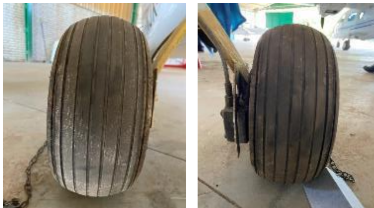
Figura 4. Marcas en el neumático del tren principal derecho
