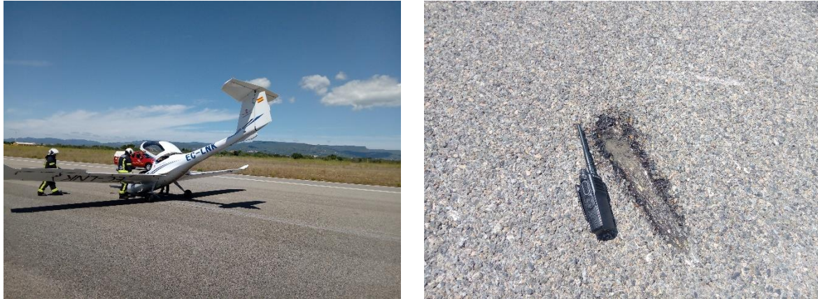
Figura 3. Aeronave detenida sobre la pista (izquierda) y huella del impacto del tren delantero (derecha)
