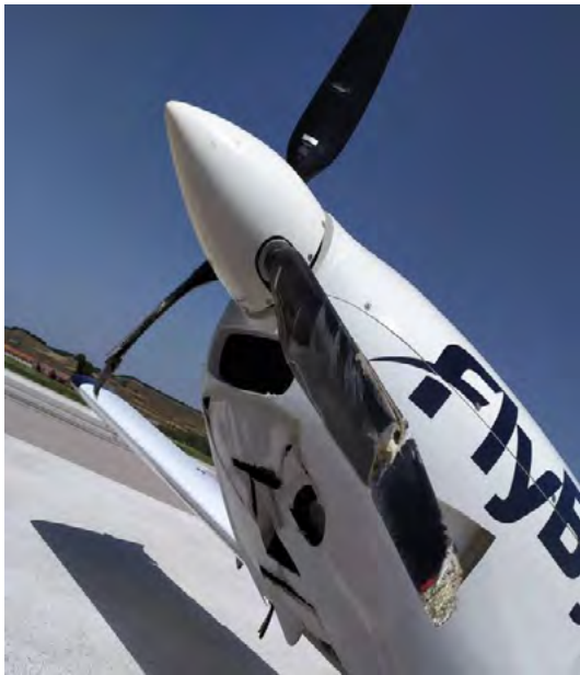
Fotografía 2. Daños en hélice
