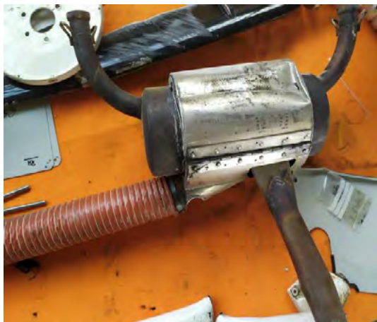
Fotografía 3. Daños en colectores de escape
