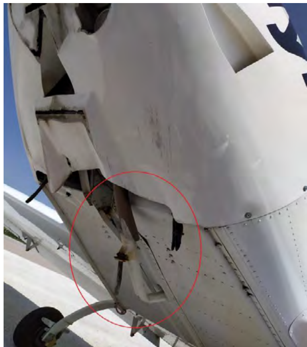
Fotografía 4. Daños en conjunto de tren de morro
