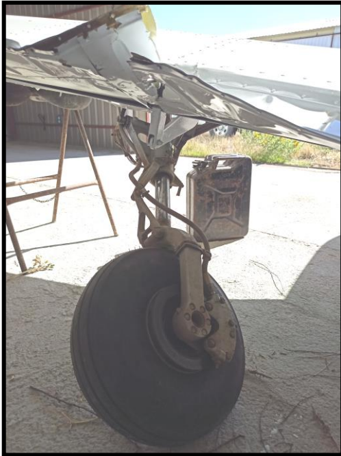
Figura 2: Detalle de los daños en el tren y en el plano.
