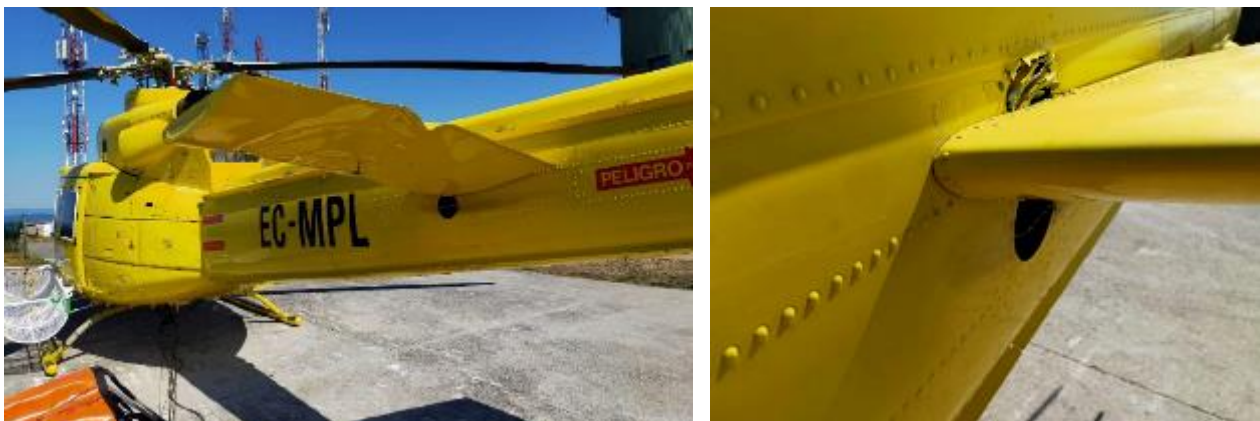
Figura 2. Daños del helicóptero EC-MPL
