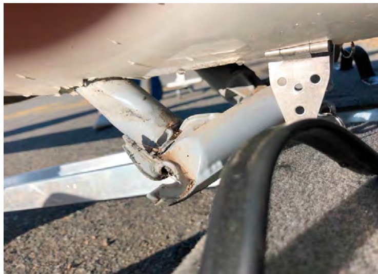
Figura 2: Daños en tren principal
