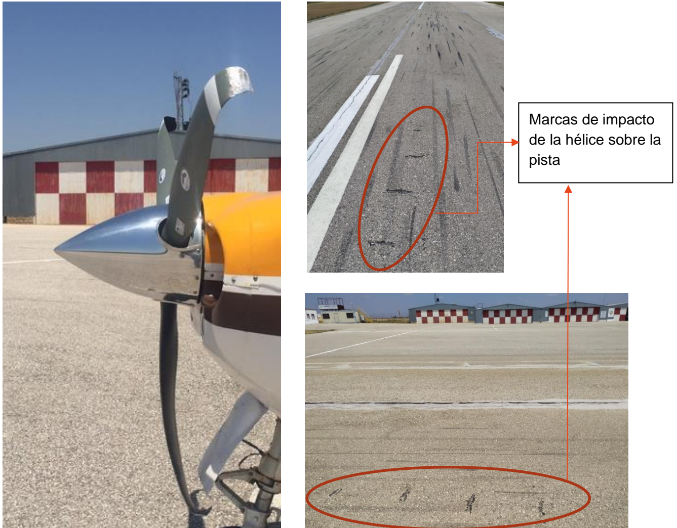
Ilustración 3 Marcas de impacto de la hélice en pista
