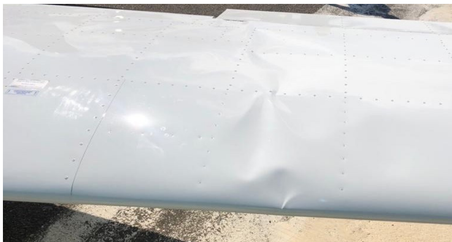
Figura 3: Detalle de los daños en los planos.
