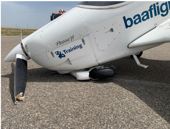
Figs. 2 y 3: Daños en parte delantera y en la punta del semiplano derecho de la aeronave
