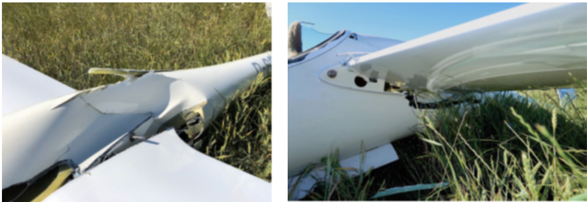
Figura nº 2.- Roturas y deformaciones en el encastre del semiala izquierda y fuselaje
