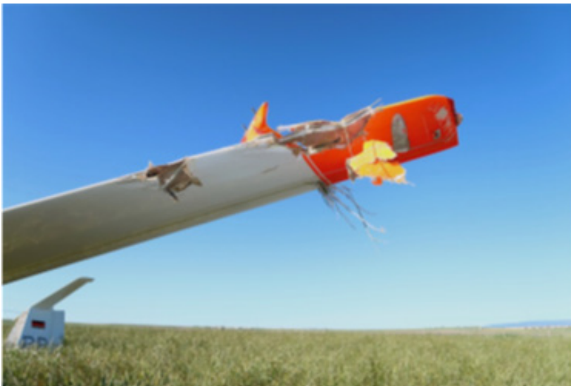
Figura nº 3.- Huellas de impactos en el extremo del semiala izquierda.
