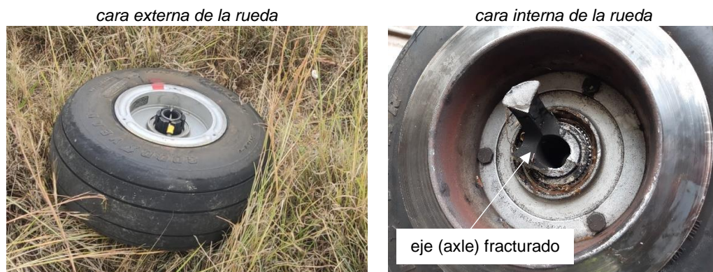
Figura 6. Rueda pata izquierda tras el accidente
