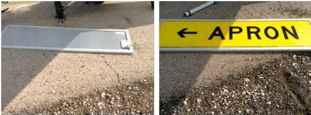
Figura 3. Cartel de señalización dañado
