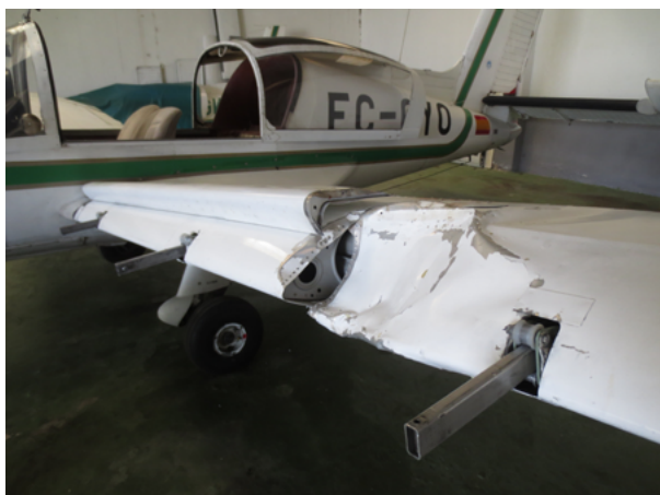
Figura 2. Deformación del borde de ataque 2
