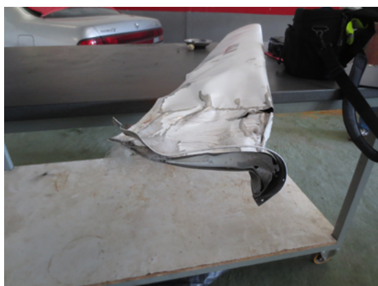
Figura 4. Deformación del slat
