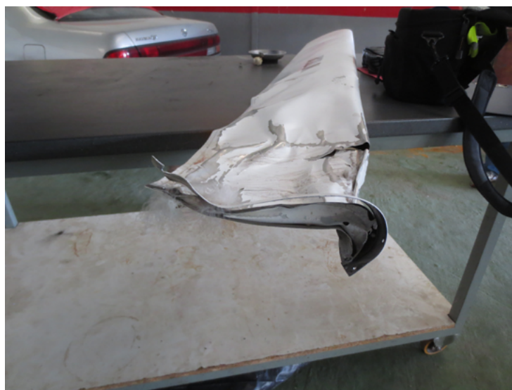
Figure 4. Deformación del slat
