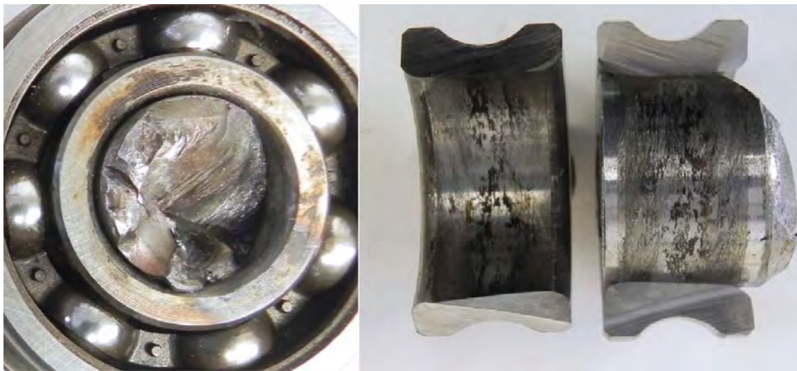
Figura 9. Cojinete de apoyo en zona de rotura
