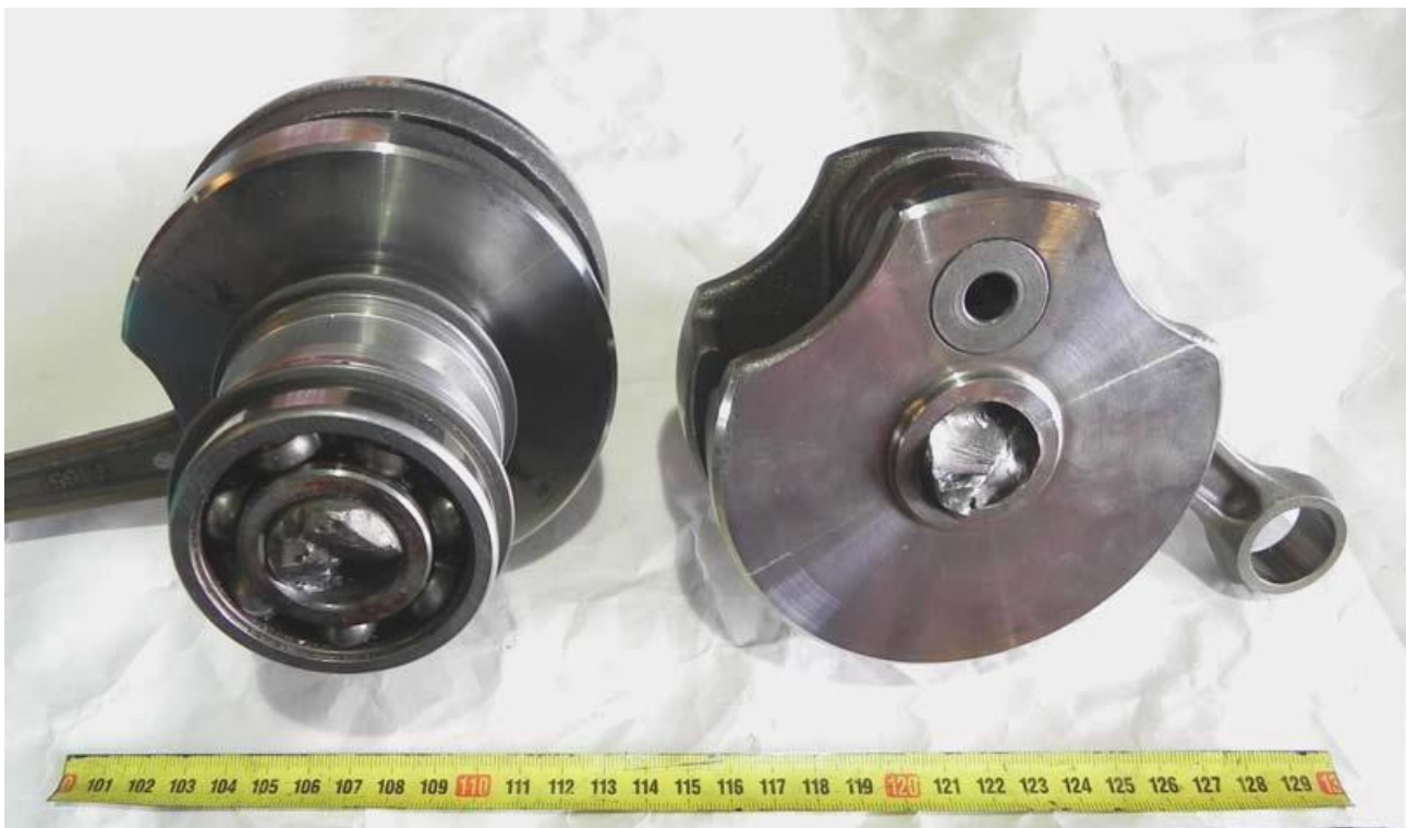
Figura 8. Fractura en cigüeñal
