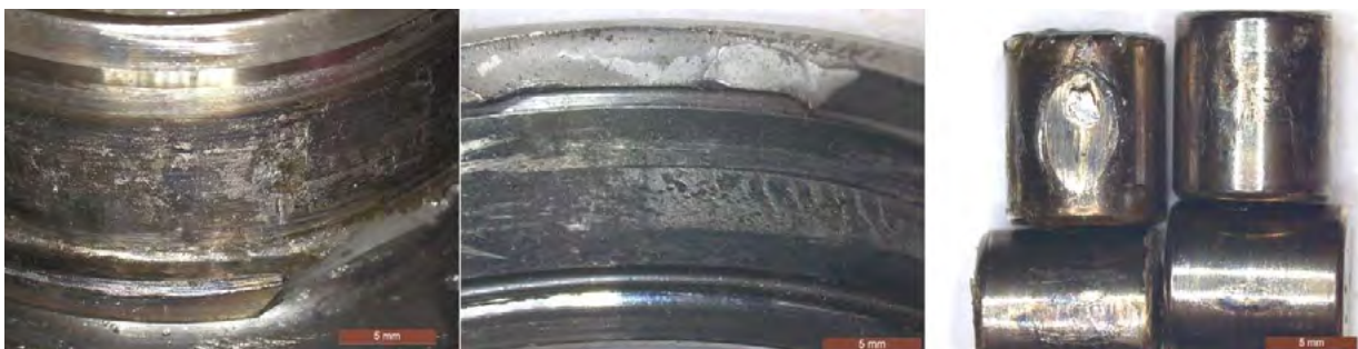
Figura 11. Daños en cigüeñal y en rodillos de cojinete
