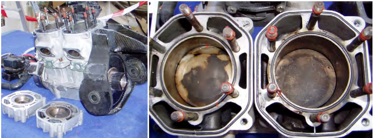
Figura 6. Desmontaje de culatas
