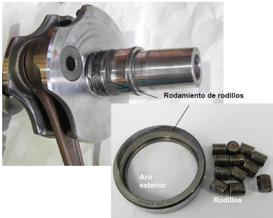
Figura 10. Cojinete de apoyo en extremo de cigüeñal
