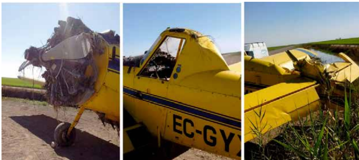
Figura 1.- Fotografías de los daños más importantes sufridos por la aeronave.
