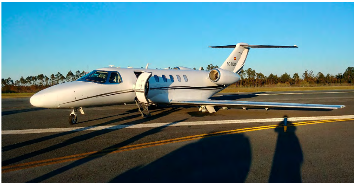
Figura nº 1.- Posición y estado de la aeronave tras el colapso de la pata izquierda
