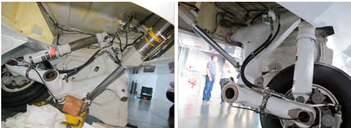
Figura nº 2.- A la izquierda pata izquierda, fuera de su alojamiento. A la derecha pata derecha, en su posición normal extendida
