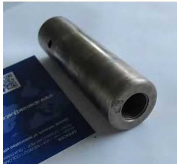
Figura nº 3.- Bulón trasero ( aft. trunnion mounting pin ) del lado izquierdo recuperado.
