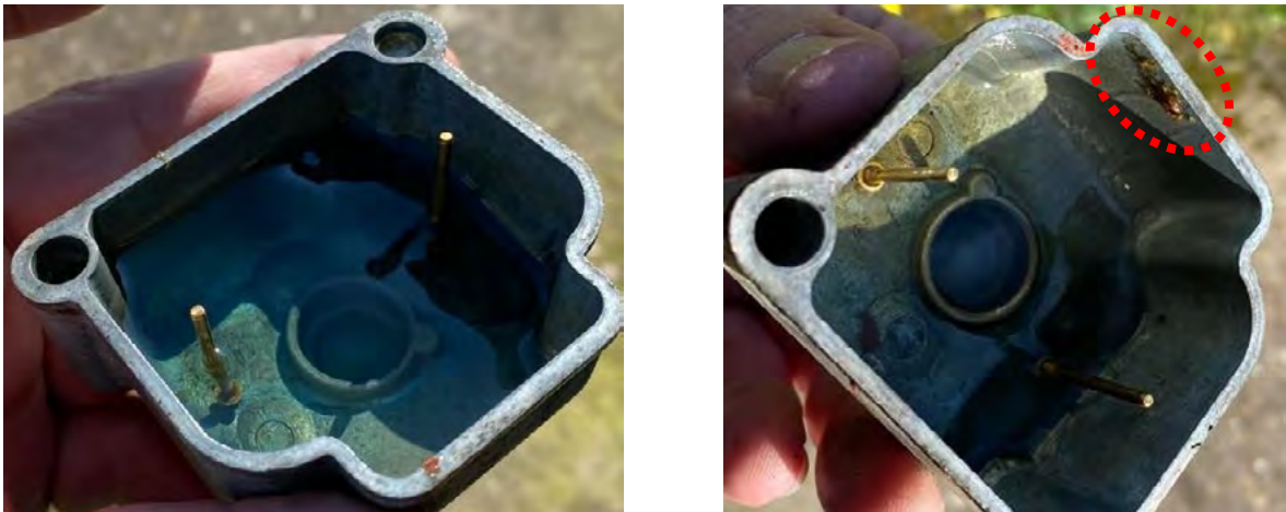
Figura 4. Fotografías de las cámaras de flotadores de los carburadores izquierdo y derecho. Se ha remarcado con línea punteada de color rojo un acúmulo de suciedad que había en la cámara del carburador derecho
